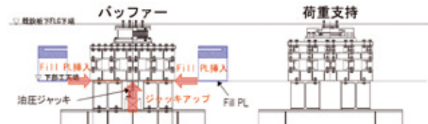
図-12 支承設置施工ステップ
