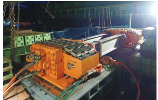
写真-11 シンクロジャッキ
