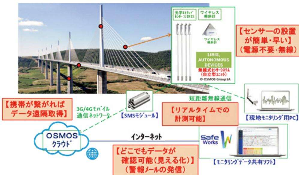
図-7 無線式センサーシステム：LIRISの概要と特徴
