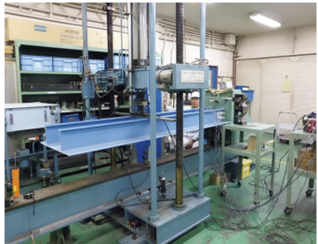
図-6 防風柵実験（前面載荷）の状況
