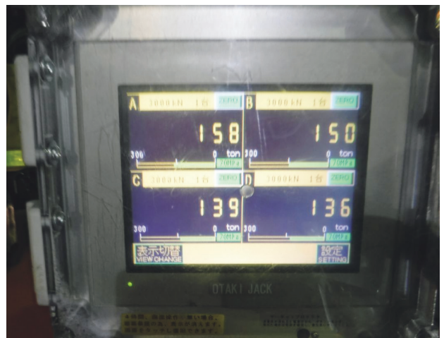
写真-9 ジャッキ反力 デジタル表示
