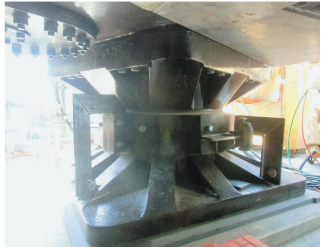
写真-8 支承回転固定治具
