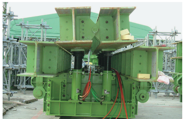
写真-2 台車ジャッキ
