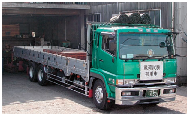
写真－2 荷重車（総重量が20tonの3軸貨物車）
