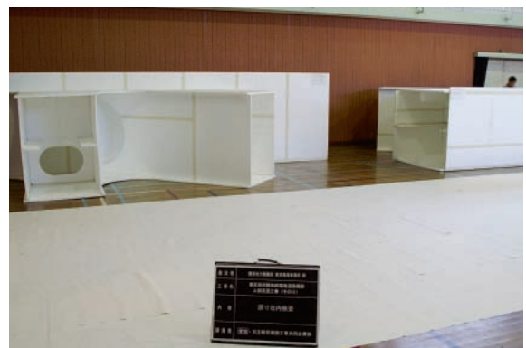
写真-1 トラス格点部の模型試験状況
