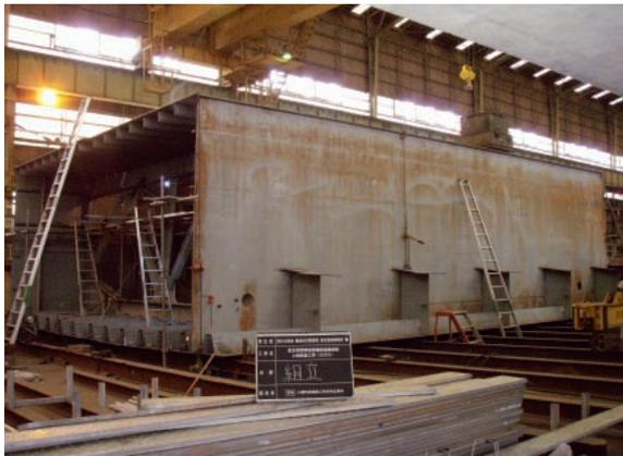
写真-4 主桁の大組立状況（組立完了）
