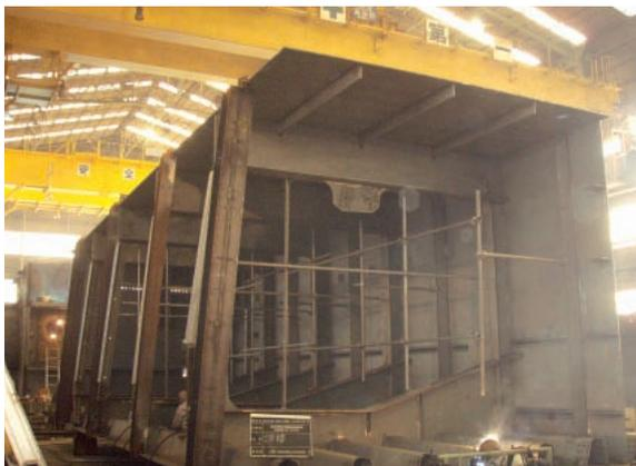
写真-5 形状保持材の取付状況
