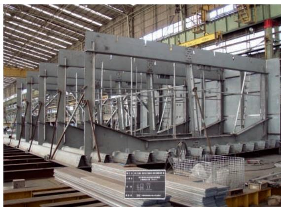
写真-3 主桁の大組立状況（横リブ立込み）
