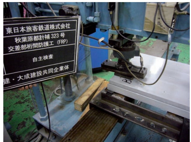
写真-2 載荷状況 (試験体B1-2b)
