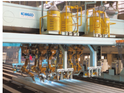
写真-3 8電極同時溶接
