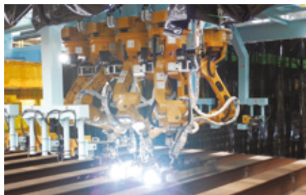
写真-1 多関節溶接ロボット
