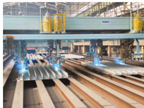
写真-4 2部材8電極同時溶接
