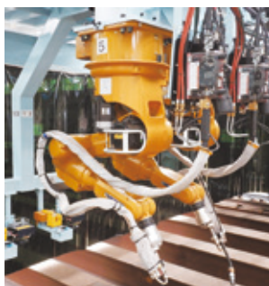
写真-5 溶接ロボット
