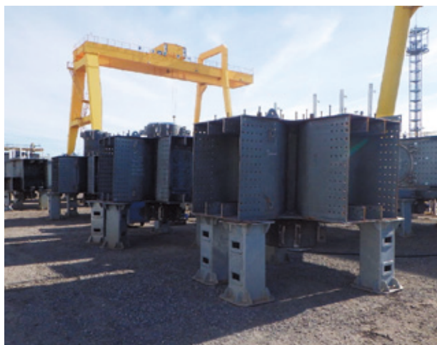
図-7 新架台を使用した部材保管
