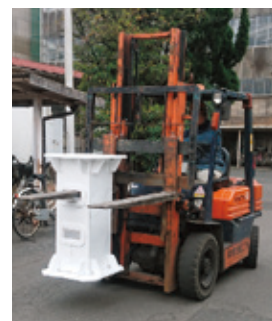
図-4 実物大模型による作業性の検証
