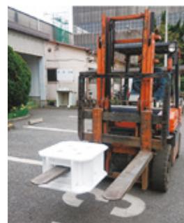
図-4 実物大模型による作業性の検証
