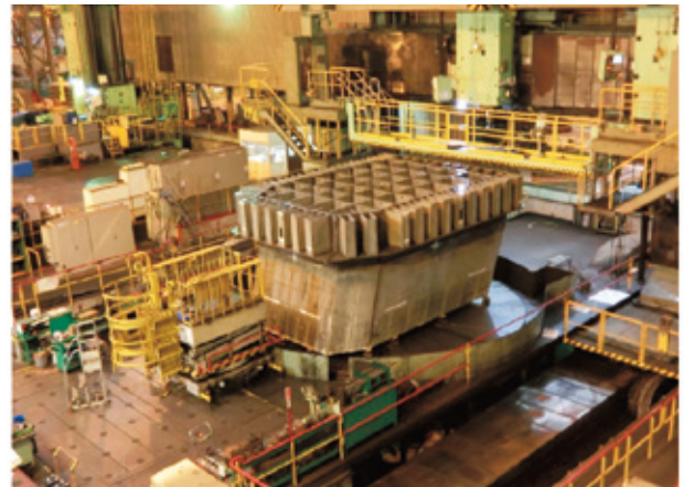
写真-4 大型立旋盤での基部加工
