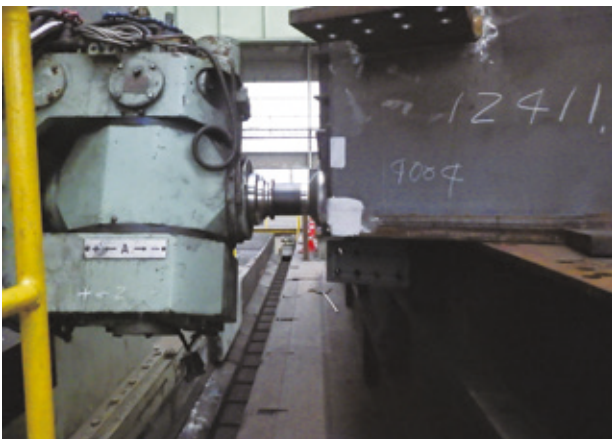
写真-2 継手部の切削加工
