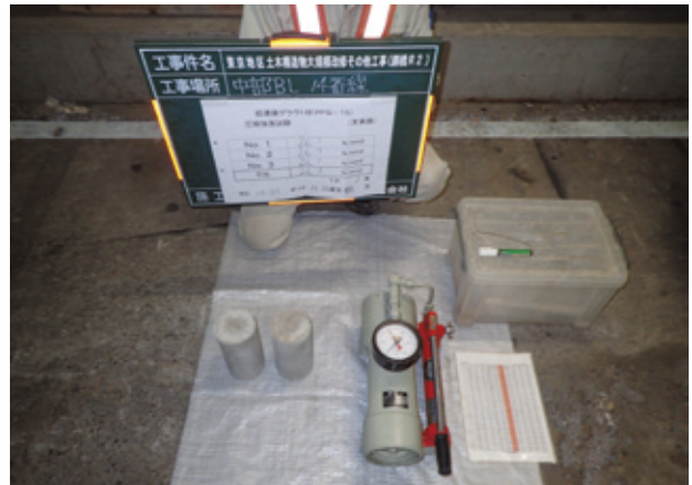
写真-13 圧縮強度試験状況
