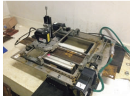
写真-7 レーザ計測状況
