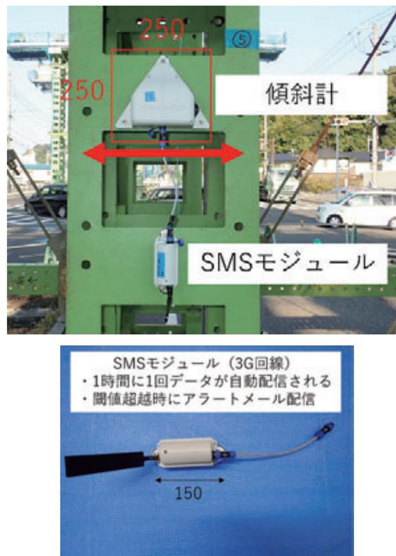
図-3 傾斜計およびSMSモジュール
