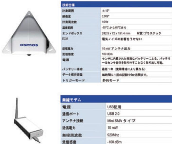
図-4 傾斜計の技術仕様および現地データ通信用モデム
