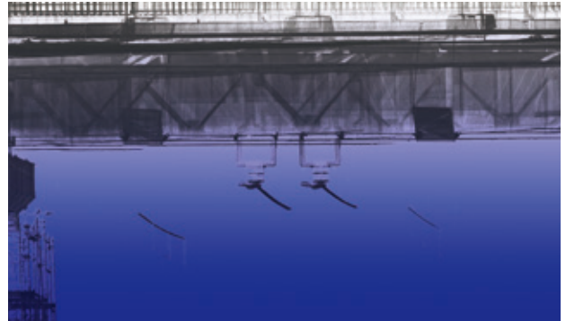
写真-16 断面架線位置確認
