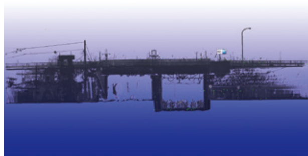
写真-7 橋梁側面点群データ
