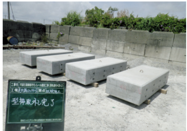
写真一八 施工試験（試験体）
