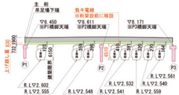
図-5 建築限界と離隔検討図
