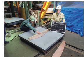
写真-2 バックルプレート検査
