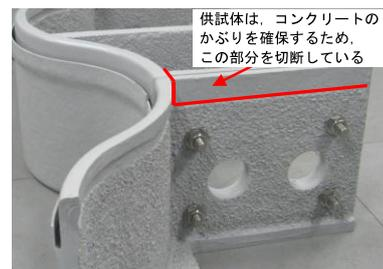
写真-1 FRP伸縮の継手構造
