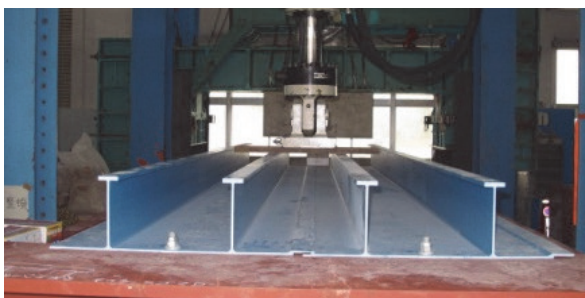
写真-4 FRP試験体設置状況
