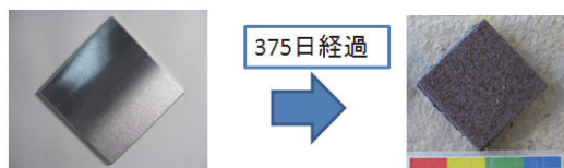
写真-3 鋼板試験片の腐食状況 (鋼桁外)
