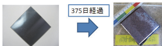
写真-2 鋼板試験片の腐食状況 (カバー内)
