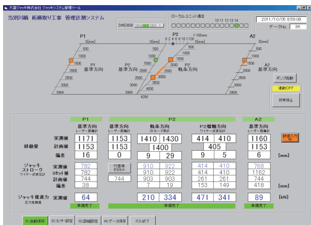
図-12 ジャッキ管理画面
