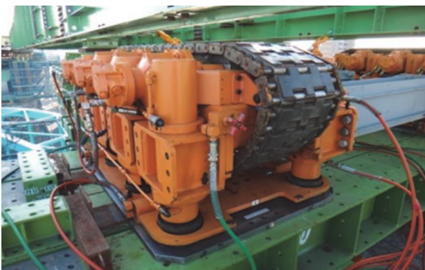
写真-3 駆動シンクロジャッキ
