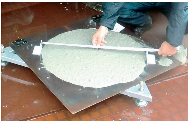
写真-4 スランプフロー試験
