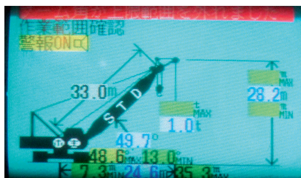
写真-4 クレーン起伏角度管理
