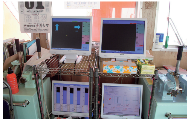
写真-5 大型起重機船作業管理システム
