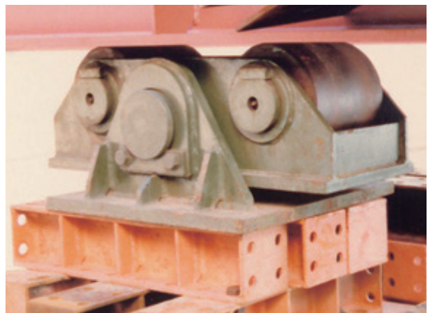
写真-11 送り出し用二軸ローラー
