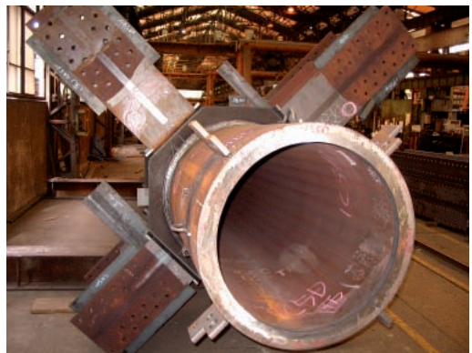
写真-11 梁仕口取付状況
