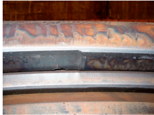
写真-1 ガス溶断加工
