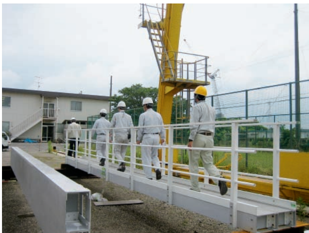
写真-5 歩行振動試験
