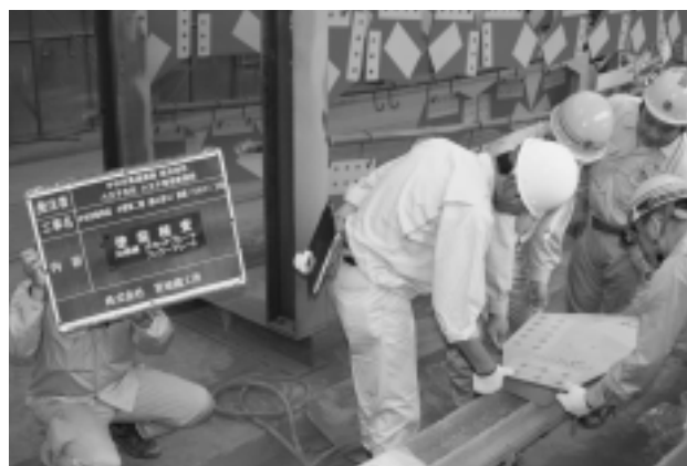
図-10 ガセットPL写真（部材検査時）
