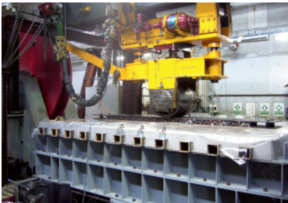
鋼材とFRPのハイブリッド型枠を用いた合成床版の輪荷重載荷試験
