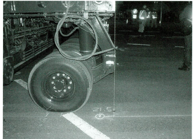
写真-12 下げ振りによる走行位置の確認状況
