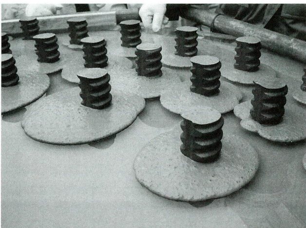
写真-7 下フランジ側供試体 コンクリートフロー状況
