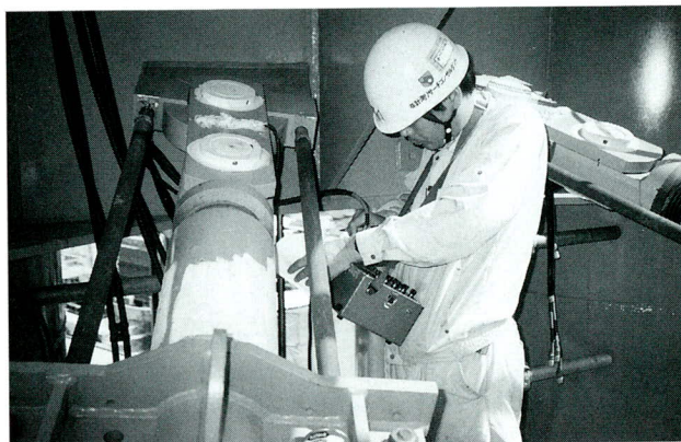
写真-7 ひずみゲージ計測状況
