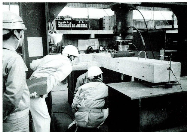
写真-2 継手構造耐力試験状況
