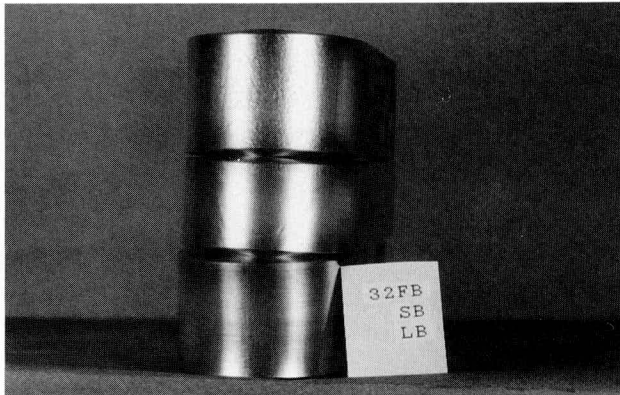
写真-5 曲げ試験片(t=32mm)
