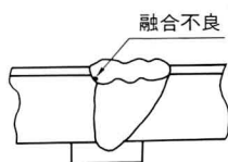
図-11 境界部欠陥例
