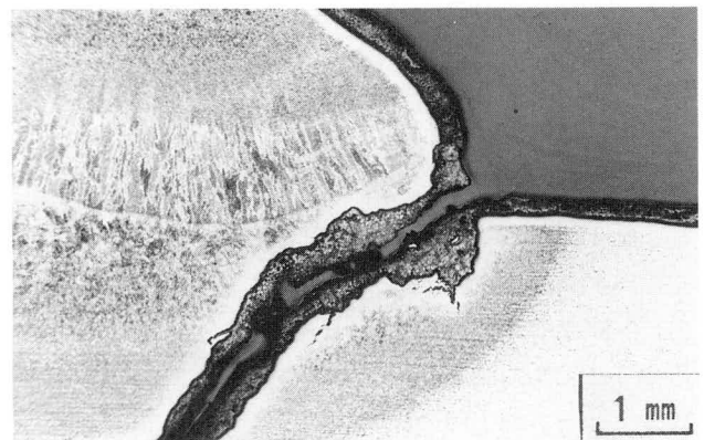
写真-2 同様のめっき割れ発生部（溶接止端部）の拡大写真
