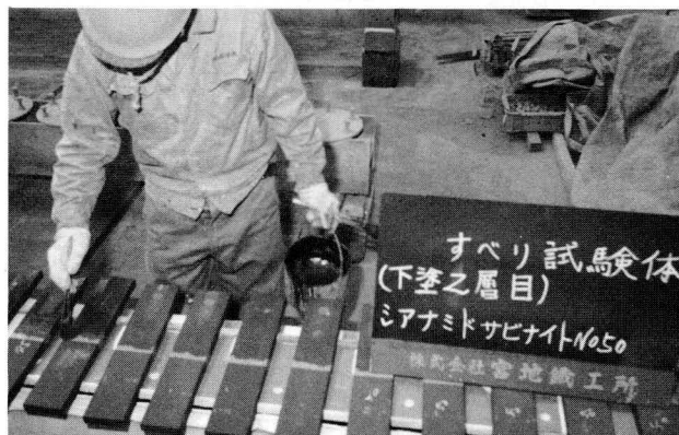
写真-2 塗装状況(鉛系サビ止め)
