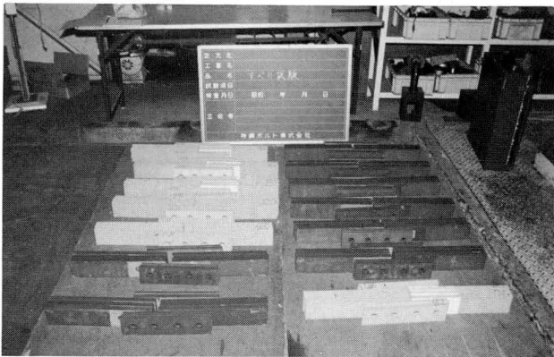
写真-4 試験体状況（組立前）
